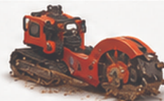
STUBBENFRÄSE Stubben und Wurzeln entfernen
