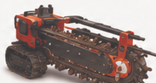
GRABENFRÄSE Für Entwässerungssysteme und Leitungsverlegung
